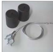
**Seilsystem** zur Abhängung für Leuchtstäbe 75-190 cm, 2 Drahtseile je 3 m mit Aufhängeösen und Clips, 2 schwarze Baldachine, 2 schwarze Kabelbinder
