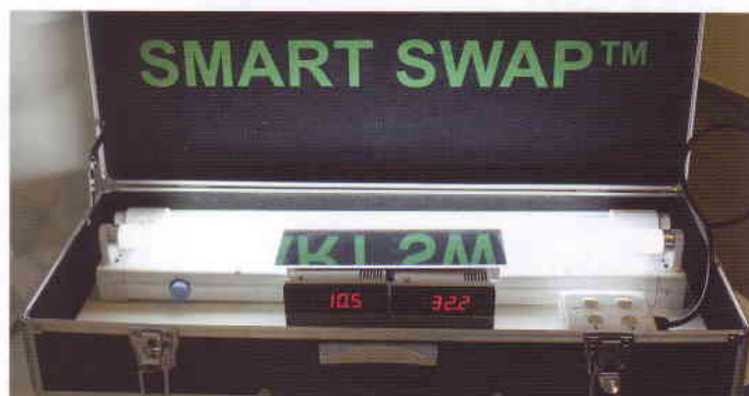
Um die Leistungsaufnahme der unterschiedlichen Leuchtstoffröhren zu vergleichen, wurde ein System zur Messung konstruiert.
